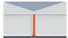
Koppelgoot tussen aluhallen
