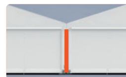
Gouttière de liaison entre les halls en aluminium
