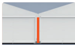
Verbindungsrinne zwischen Alu-Hallen
