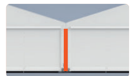
Canal de acoplamiento entre pabellones de aluminio
