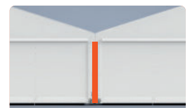
Verbindungsrinne zwischen Alu-Hallen
