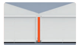
Verbindungsrinne zwischen Alu-Hallen
