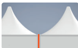
Gouttière de liaison entre les pagodes
